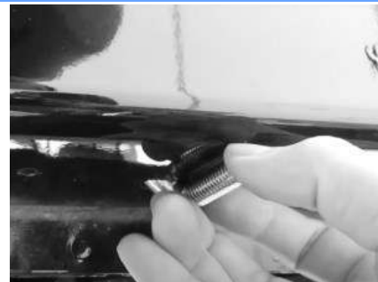
(Fig 3b) Insert (1) M10 J-Bolt
