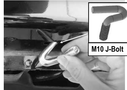
(Fig 3a) Insert (1) M10 J-Bolt
